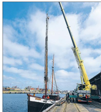
Ein Schwerlastkran zieht den rund 1,6 Tonnen schweren und 27 Meter langen Großmast aus dem Schiff.
